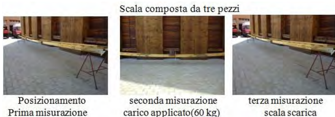
Figura 31: 2° fase del collaudo eseguito con scala posizionata orizzontalmente.
