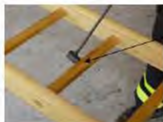
Figura 29: Particolari dei controlli su incastri, tirante d'acciaio, verniciatura e gradini della scala.
