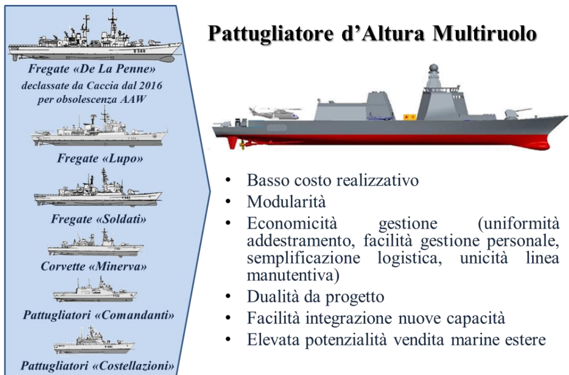
Fig. 7 – La sostituzione di più classi di navi con un unico tipo di unità multiruolo.
